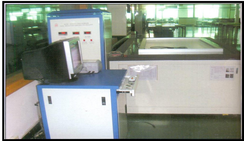
Solar Module Tester
